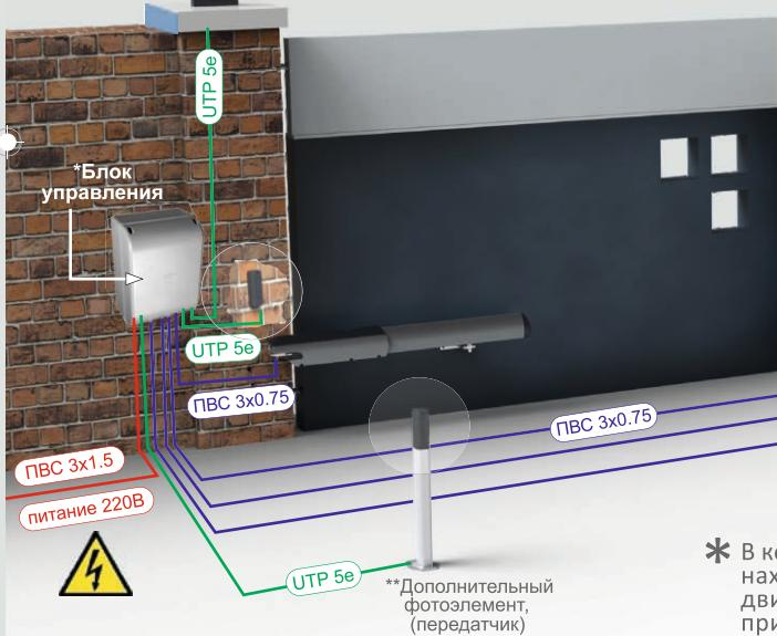
\* В комплекте FAST блок управления находится в корпусе одного из двигателей. Учитывайте это при трассировании кабелей.
