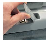
Внешняя конструкция, изготовленная полностью из алюминия, гарантирует высокую прочность и защиту от атмосферных воздействий. Удобный встроенный механизм разблокировки с помощью ключа позволяет вручную разблокировать привод при необходимости.
